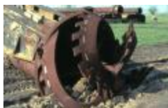
Boorkop en baggerbuizen (PCPP20110926026)
